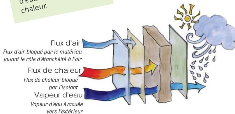
4. Il faut veiller à ce que les matériaux composant la paroi soient de plus en plus ouverts à la vapeur d'eau, de l'intérieur vers l'extérieur. Un rapport de 5-1 est conseillé. Autrement dit, le matériau situé le plus à l'intérieur du bâtiment doit être 5 fois plus fermé à la vapeur que celui situé sur la face extérieure de la paroi isolée.
