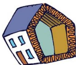
L'**isolation** doit être continue, tout défaut ou insuffisance d'isolant crée un pont thermique (endroit par lequel la chaleur passe et donc se perd).
