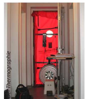
A gauche : Infiltrations d'air fréquentes dans les bâtiments. A droite : Test blower door - côté extérieur et intérieur.
