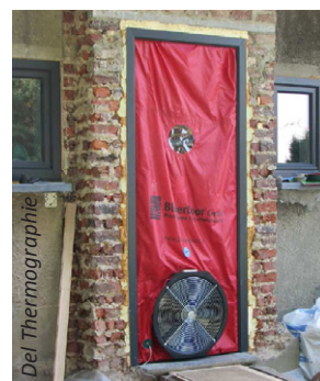
A gauche : Infiltrations d'air fréquentes dans les bâtiments. A droite : Test blower door - côté extérieur et intérieur.
